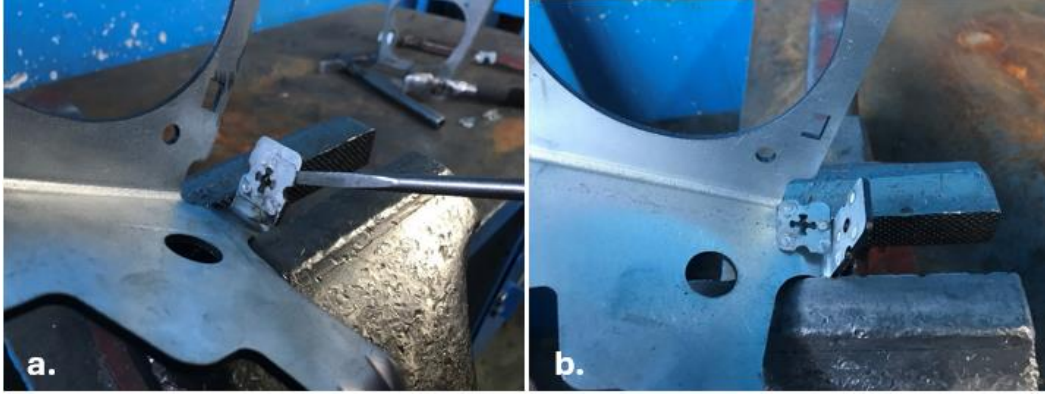
Şekil 3.a ) 0.5 mm kalınlığındaki detay parça projeksiyon kaynak mukavemeti keski – çekiç yöntemi b) tahribatlı muayene sonucu
