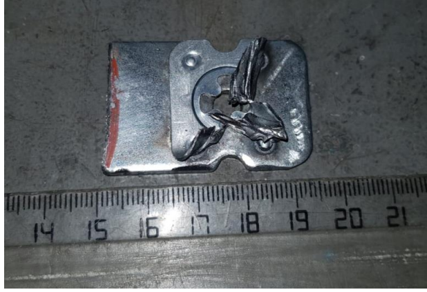
Şekil 10. Keski-çekiç tahribatlı test yöntemi ile test edilen sac numune örneği
