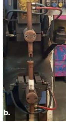
Şekil 7.a) Üst bakır elektrot teknik resim perspektif görünüş b) AC/DC kaynak makinesine bağlı U geometrili bakır elektrod
