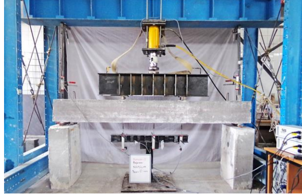
Şekil 3. Yükleme düzeneği ve ölçüm aletlerinin konumları
